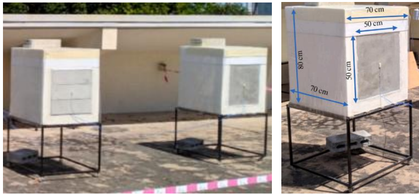
صورة (5): أبعاد المجسم الذي استخدم في تجربة خفض الحرارة باستخدام الواجه الاسمنت مع PCM [13]
