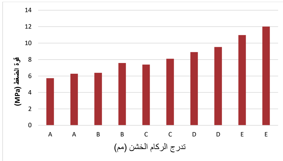
الشكل (6): قوة الضغط عند 28 يوم لكل الخلطات الخرسانية (A,B,C,D,E)
