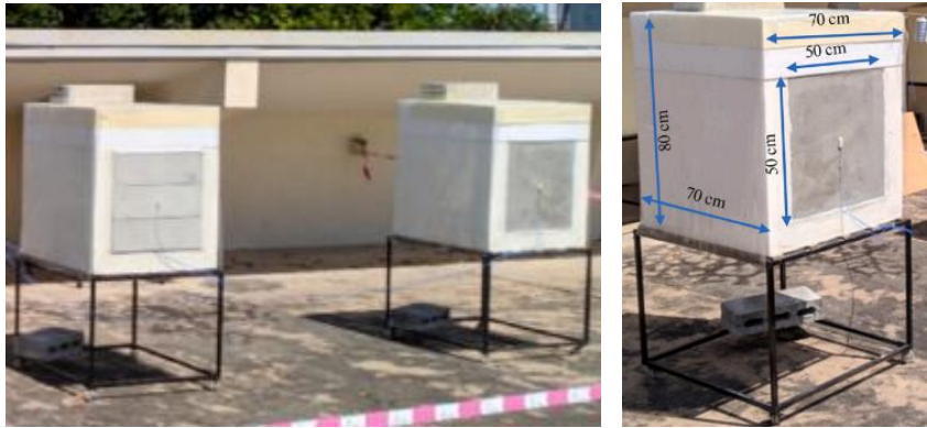
صورة (5): أبعاد المجسم الذي استخدم في تجربة خفض الحرارة باستخدام الواح الاسمنت مع PCM [13]
