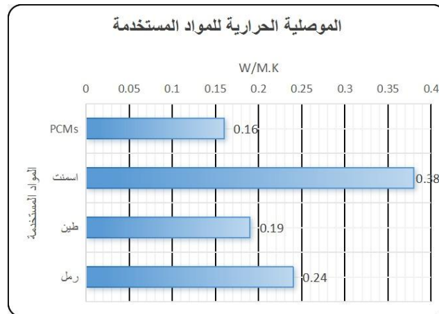
صورة (15): رسم بياني يوضح الموصلية الحرارية للمواد المستخدمة في الاختبارات
