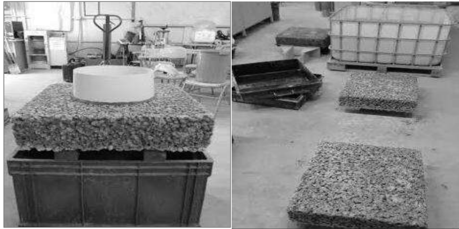
الشكل (4): إزالة العينات من القوالب ووضع حلقة التسرب
